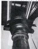
1168 2 5/ Feb /00 Kew Bridge Steam Museum, Cornish, Cornish Engine. 他機のパンプ種、これ だけで20トン、これがまるで魔法にかかっ たように蒸気の引き下でフワ〜と昇る。
